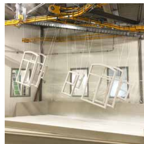
Auf der neuen Anlage können Elemente mit Maßen von bis zu 5 x 3 Metern in einem Stück beschichtet werden.
