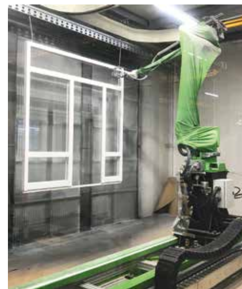
Die erste Lackierung im Spritzverfahren mit dem wasserbasierten Zwischenlacken Induline LW-715E/20 (lasierend) oder Induline ZW-400 (deckend) erfolgt über zwei Roboter, die auf Verfahrwagen montiert sind.
